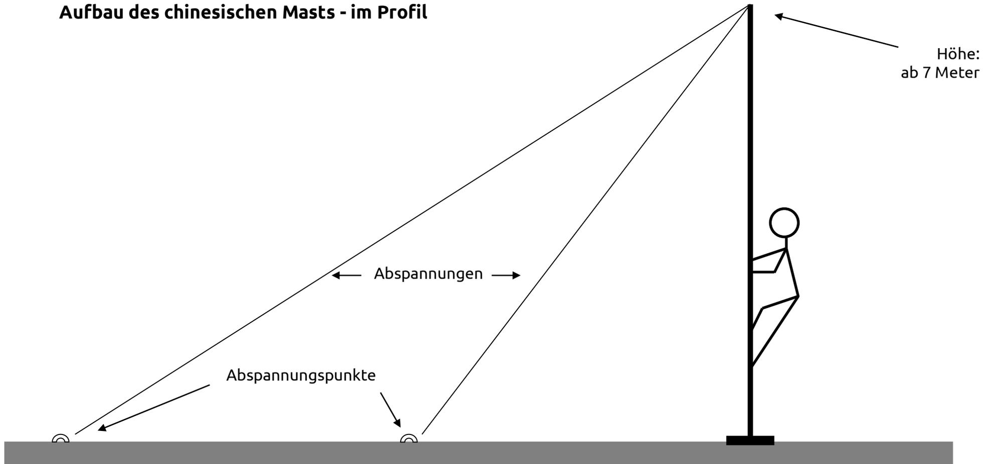
Für die vertikale Stange werden 4 Punkte benötigt, an denen der Mast abgespannt wird. Optimaler Weise am Rand der Spielfläche und in gleichmäßigem Abstand zueinander. Jeder Abspannpunkt muss mindestens 400kg Zuglast halten!
